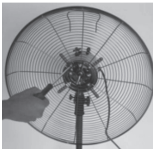
Tornillos de fijación exteriores de la cubierta frontal del motor
